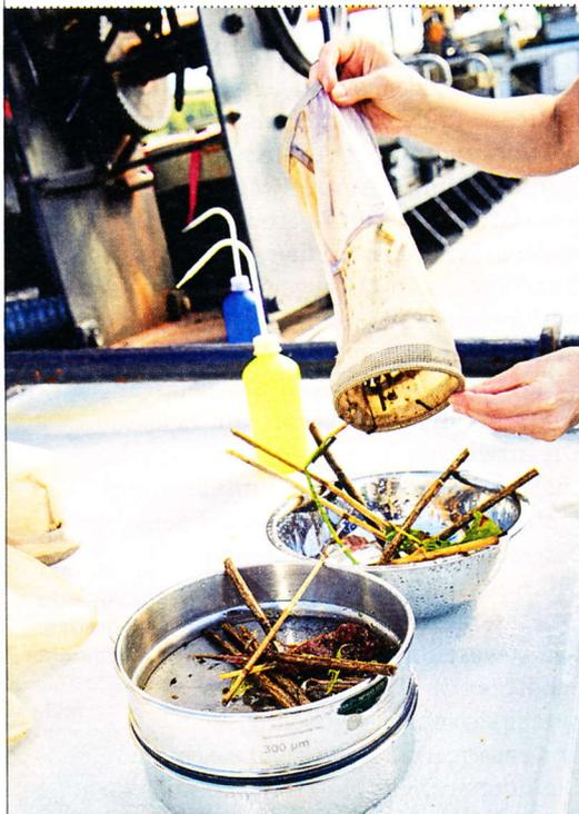
Müllwäsche: Auf dem Greenpeace-Schiff wird Probenmaterial gespült, gesiebt und sortiert
